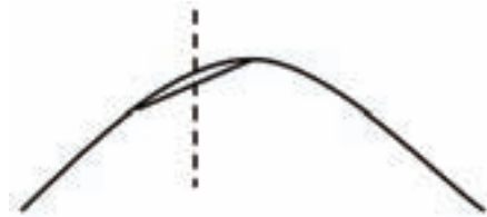
图 5 “过顶”现象及插值误差示意 方位角的“过北”和角度插值精度问题本质上
