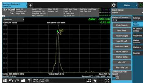
图 11 目标回波速度调制实测结果
